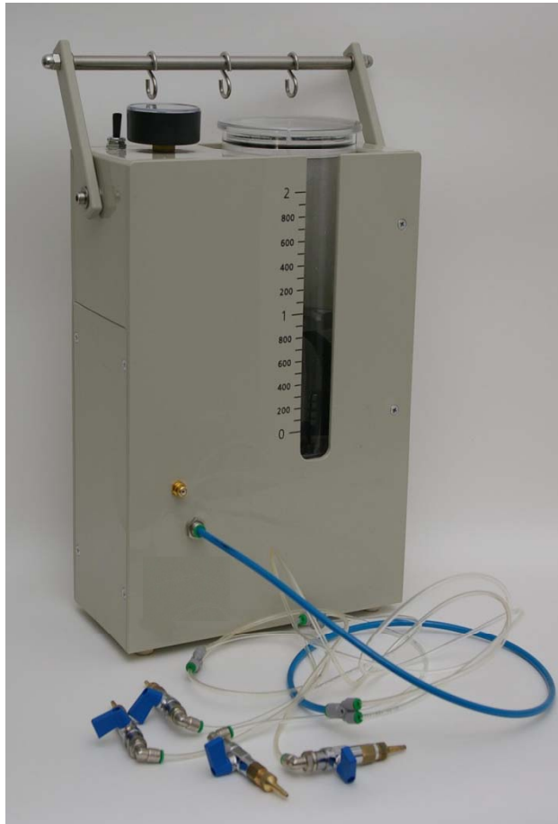
macchina per endoterapia a bassa pressione
